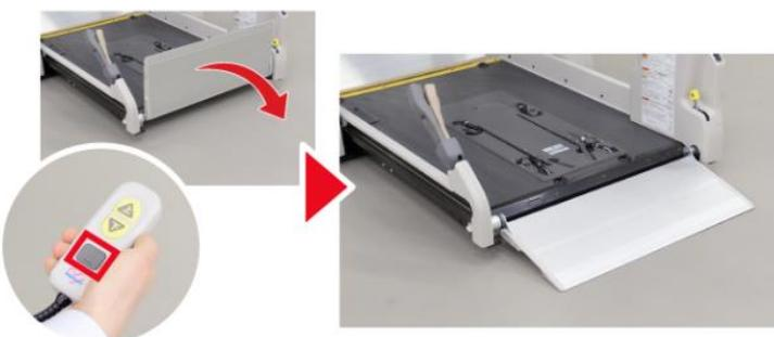
操作スイッチの倒しボタンを押し続け、後退防止用ストッパーを倒す
