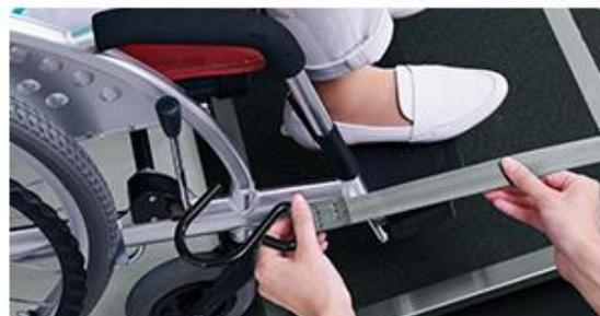
ウインチベルトを引き出し、車いす前輪上のフレームにフックをかけます。
